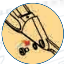
FRIZIONE TRA LE LAME REGOLABILE TRAMITE VITE
